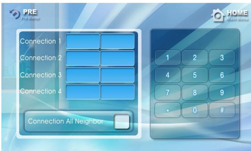
Данная функция позволяет осуществлять связь с разрешенными или уже зарегистрированными соседями. Возможность ввода - до 4 номеров соседних жилых помещений.
